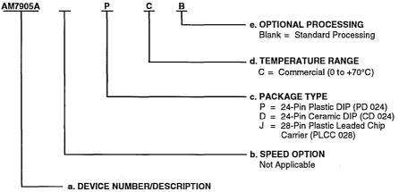
Am7905A Subscriber Line Audio-Processing Circuit (SLAC) WORLD-CHIP B
