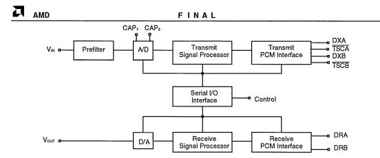
Figure 2. SLAC Block Diagram
