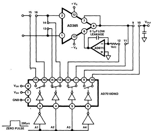
Figure 20. Auto-Zero Circuit
