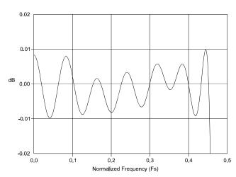
Figure 17. ADC Passband Ripplee
