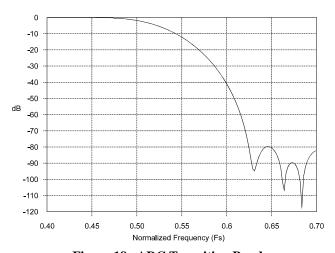
Figure 18. ADC Transition Band
