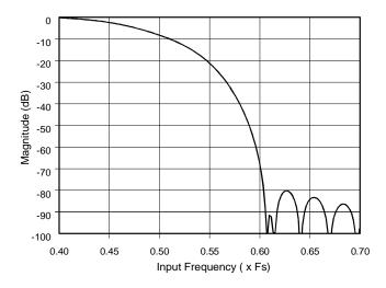
Figure 28. ADC Transition Band
