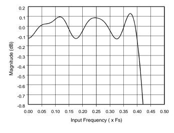
Figure 27. ADC Passband Ripple
