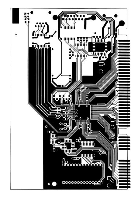
Figure 19. CRD8900 Top-Side Routing
