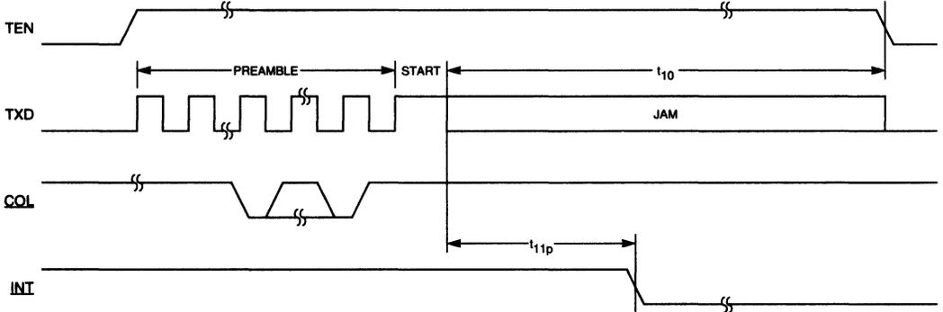
Figure 29. Transmit Timing
