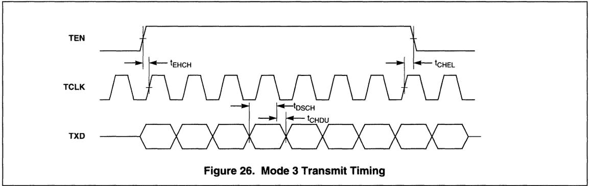
Figure 26. Mode 3 Transmit Timing
