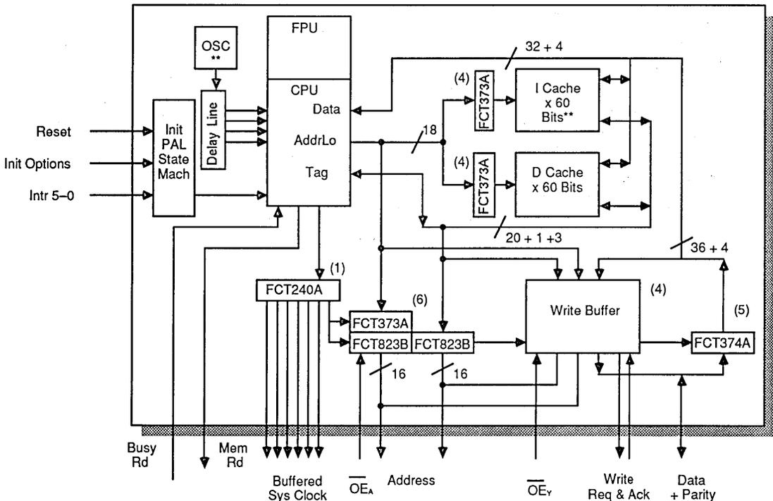
Figure 5. IDT RISC Subsystem
