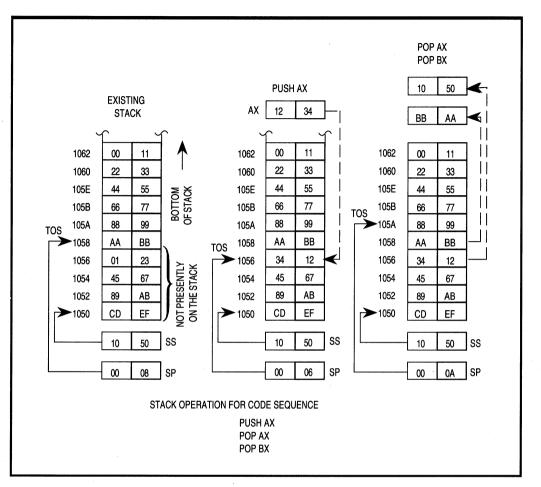
Figure 2.10. Stack Operation
