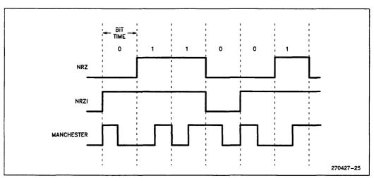
Figure 3.12. Transmit Waveforms
