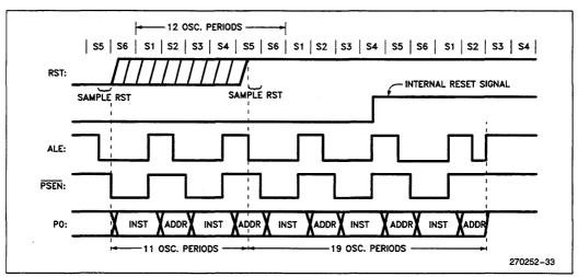
Figure 25. Reset Timing
