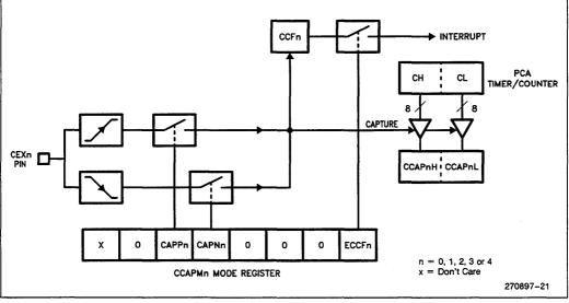
Figure 19. PCA 16-Bit Capture Mode
