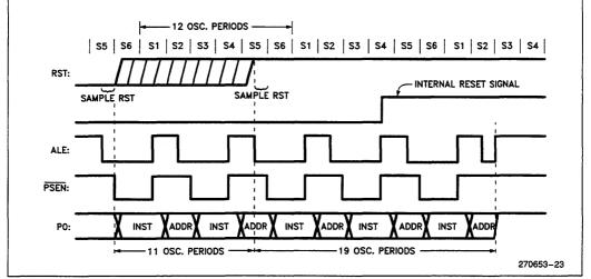
Figure 26. Reset Timing
