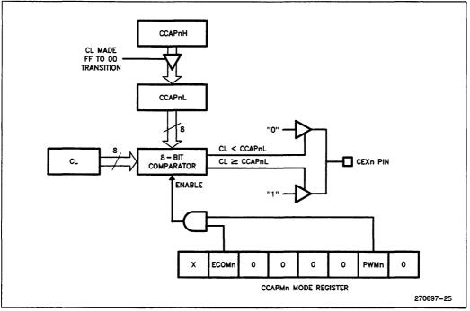
Figure 23. PCA 8-Bit PWM Mode
