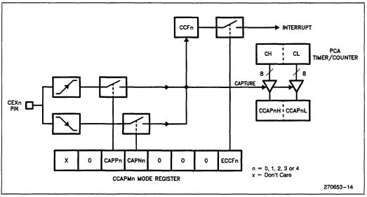
Figure 17. PCA 16-Bit Capture Mode
