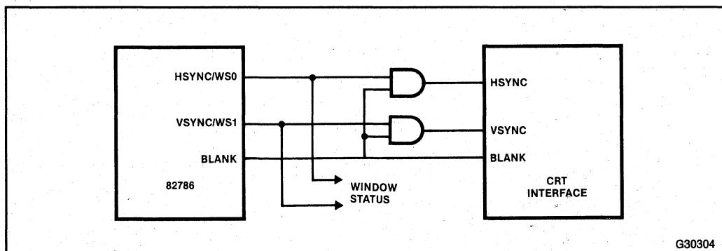
Figure 6-9. Blank Demultiplexes Window Status Pins
