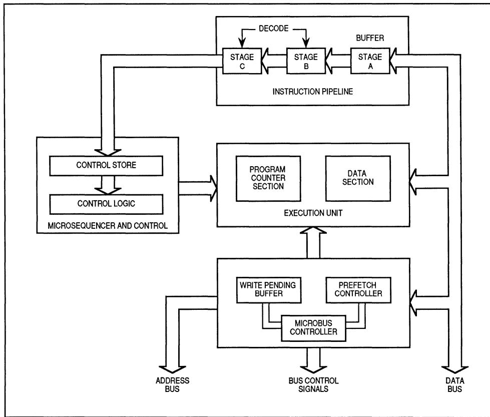
**Figure 7-9. CPU32 Block Diagram**
