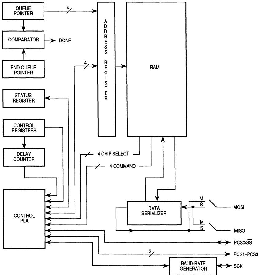
Figure 5-10. QSPI Submodule Diagram
