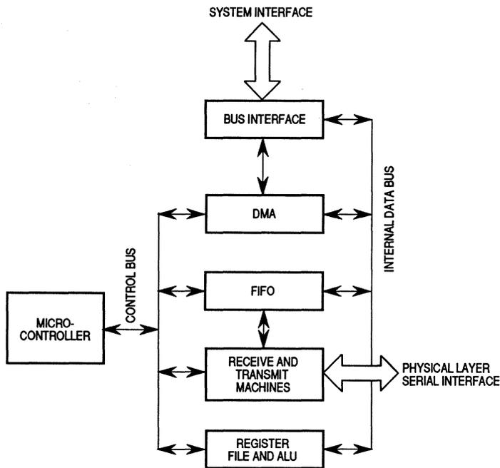
Figure 1-2. MC68605 Block Diagram
