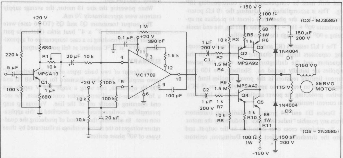
FIGURE 9 — LINE OPERATED SERVO AMPLIFIER
