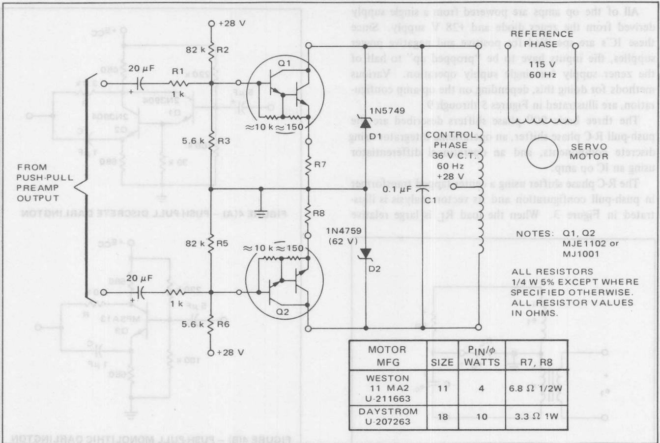
FIGURE 2 - SERVO MOTOR POWER AMPLIFIER
