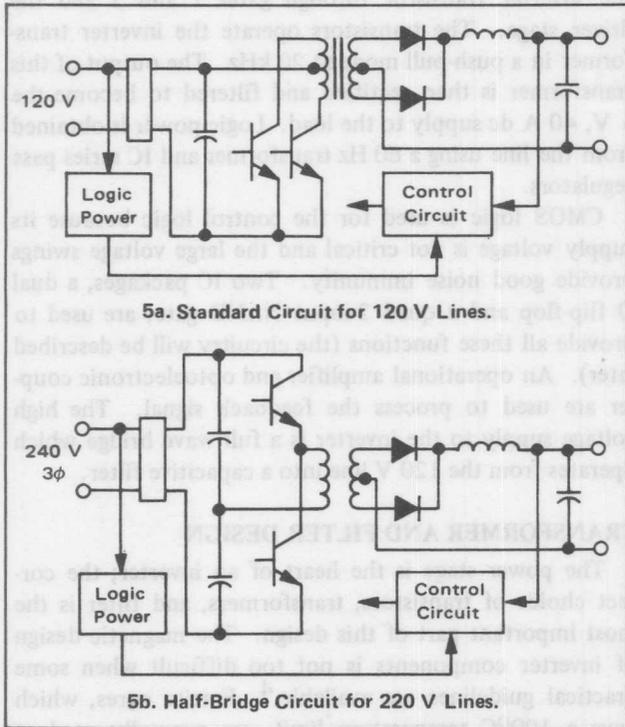
FIGURE 5 - Inverter Circuits
