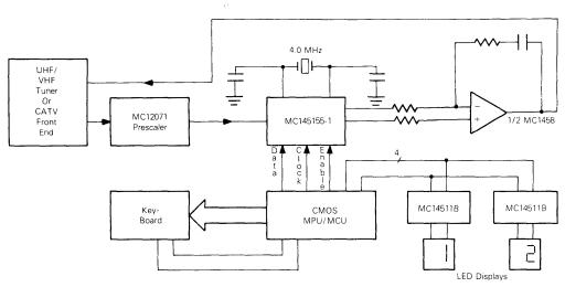
FIGURE 10 - FM/AM RADIO SYNTHESIZER
