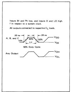
FIGURE 4 -- DYNAMIC SIGNAL WAVEFORMS
