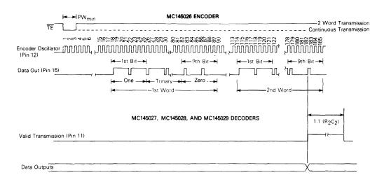
FIGURE 7 - MC145026 ENCODER DATA WAVEFORMS
