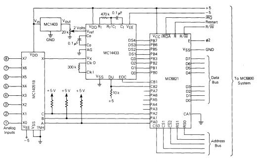
FIGURE 17 - CHANNEL DATA ACQUISITION HARDWARE
