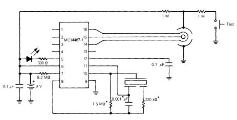
FIGURE 1 — TYPICAL APPLICATION AS IONIZATION SMOKE DETECTOR
