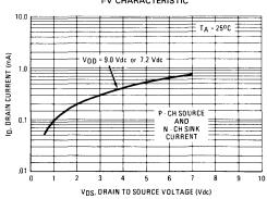
FIGURE 3 — TYPICAL P HORN DRIVER OUTPUT I-V CHARACTERISTIC
