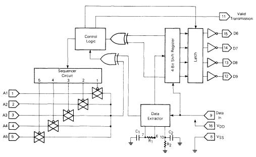
FIGURE 3 - MC145028 DECODER BLOCK DIAGRAM
