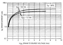
FIGURE 4 — TYPICAL P HORN DRIVER OUTPUT I-V CHARACTERISTIC
