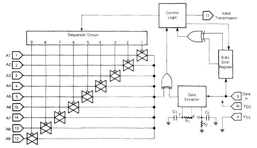
FIGURE 4 - MC145029 DECODER BLOCK DIAGRAM
