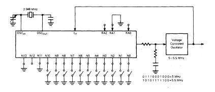
FIGURE 7 - SYNTHESIZER FOR LAND MOBILE RADIO UHF BANDS
