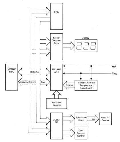
FIGURE 4 - TYPICAL MC14442 APPLICATION IN A CLIMATE CONTROLLER
