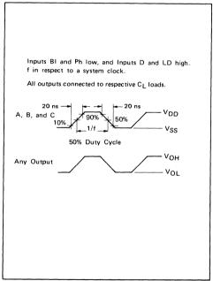
FIGURE 4 - DYNAMIC SIGNAL WAVEFORMS
