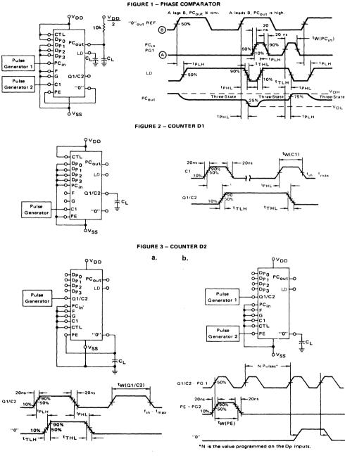
SWITCHING TIME TEST CIRCUITS AND WAVEFORMS
