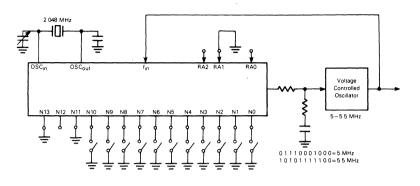
FIGURE 6 - 5 MHz TO 5.5 MHz LOCAL OSCILLATOR CHANNEL SPACING = 1 kHz
