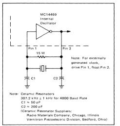
FIGURE 1 - OSCILLATOR CIRCUIT
