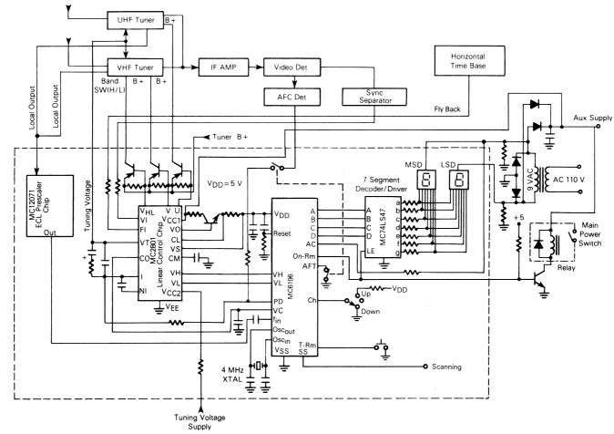
FIGURE 5 - USA TV TUNING SYSTEM BLOCK DIAGRAM
