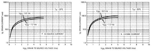
FIGURE 5 - TYPICAL COMPARATOR OUTPUT I-V CHARACTERISTIC
