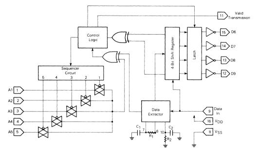
FIGURE 2 - MC145027 DECODER BLOCK DIAGRAM
