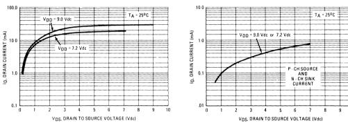
FIGURE 3 – TYPICAL P HORN DRIVER OUTPUT I-V CHARACTERISTIC
