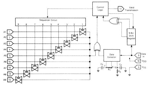
FIGURE 4 - MC145029 DECODER BLOCK DIAGRAM
