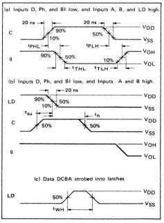
FIGURE 4 - DYNAMIC SIGNAL WAVEFORMS
