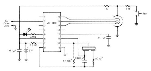
FIGURE 4 - TYPICAL APPLICATION AS IONIZATION SMOKE DETECTOR
