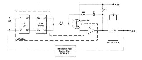
FIGURE 5 — MTTL-MECL PHASE-LOCKED LOOP
