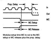
FIGURE 2 — TYPICAL OUTPUT WAVEFORMS
