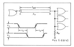
FIGURE 23b — PARALLEL TERMINATION — THEVENIN EQUIVALENT
