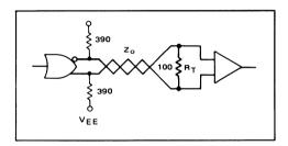
FIGURE 26 -- PARALLEL FANOUT TECHNIQUES
