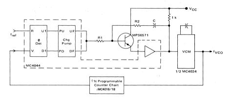
FIGURE 4 - TTL-MECL PHASE-LOCKED LOOP
