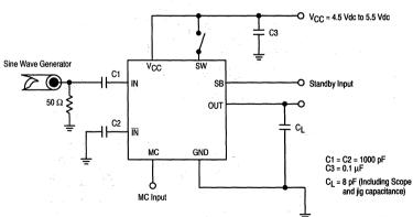
FIGURE 3 — AC TEST CIRCUIT
