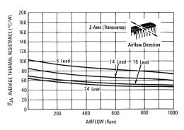
FIGURE 16D — AMBIENT TEMPERATURE DERATING CURVES (PLCC PACKAGE)
