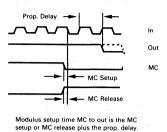
FIGURE 2 — TYPICAL OUTPUT WAVEFORMS
