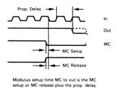
FIGURE 2 — TYPICAL OUTPUT WAVEFORMS
