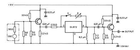
Fig. 3 Test circuit.
