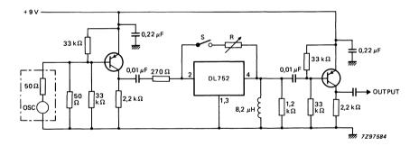
Fig. 3 Test circuit.
