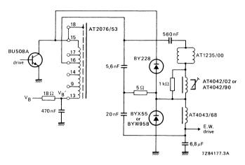
Fig. 5a Diode modulator,  $V_B = 154,5 \text{ V}$ .
