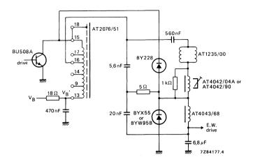
Fig. 5a Diode modulator,  $V_B = 154,5 V$ .
