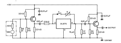
Fig. 3 Test circuit.
