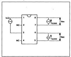
Figure 3 : Leakage Current.
