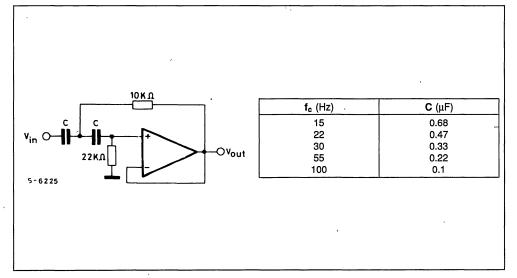
Figure 22 : High Cut Filter ( $G_v = 0 \text{ dB}$ ).
