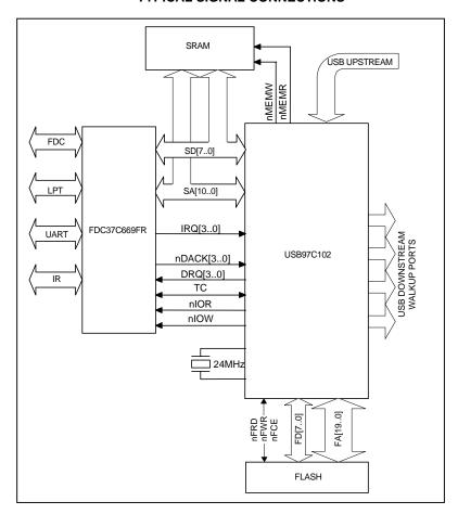
FIGURE 5 - USB97C102 CONFIGURED WITH FDC CONTROLLER AND WALKUP PORTS
