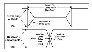
FIGURE 11 - CABLE DELAY
