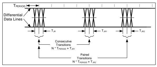
FIGURE 14 - RECEIVER JITTER TOLERANCE
