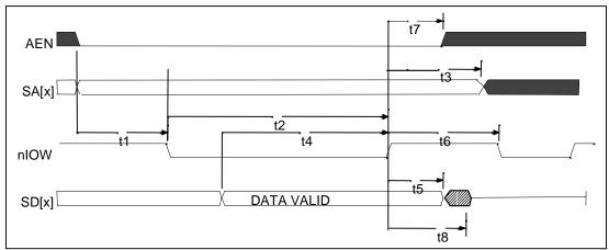
FIGURE 15 - 8051 IO WRITE CYCLE
