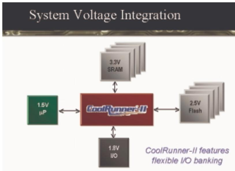
FIGURE 2-38: SYSTEM VOLTAFE INTEGRATION EXAMPLE
