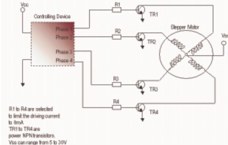
FIGURE 7-1: STEPPER MOTOR CONTROLLER
