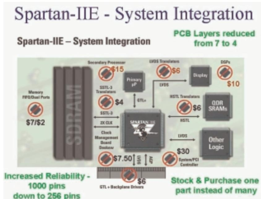
FIGURE 2-7: SPARTAN-IIIE SYSTEM INTEGRATION
