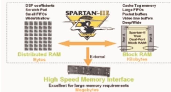
FIGURE 2-13: SPARTAN-IIIE ON-CHIP MEMORY
