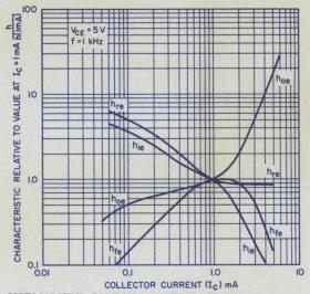
NORMALIZED COMMON EMITTER CHARACTERISTIC VS. COLLECTOR CURRENT FIGURE 11
