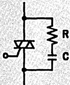
6A) SNUBBER CIRCUIT: SLOWS CHANGE IN VOLTAGE ACROSS TRIAC (INDUCTIVE KICK CAN CHANGE VOLTAGE SO FAST TRIAC WON'T TURN OFF).
