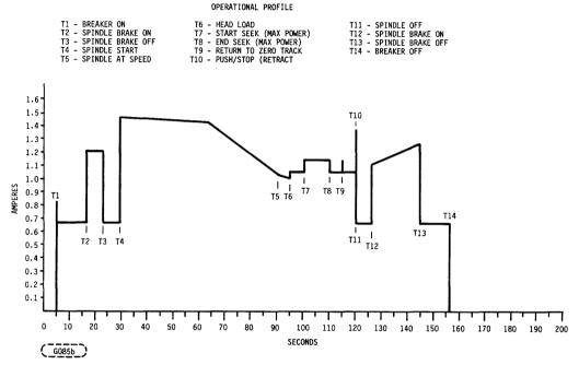
FIGURE 3-4. OPERATIONAL NOMINAL LINE CURRENTS TO POWER SUPPLY VS TIME (120 V INPUT)
