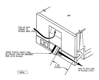
FIGURE 2-4. EMERGENCY/DRIVE FAILURE CARTRIDGE DOOR OPENING PROCEDURE
