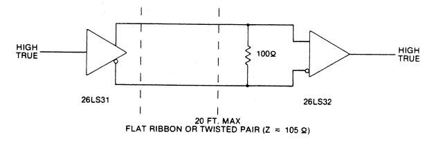
FIGURE 11. DATA LINE DRIVER/RECEIVER
