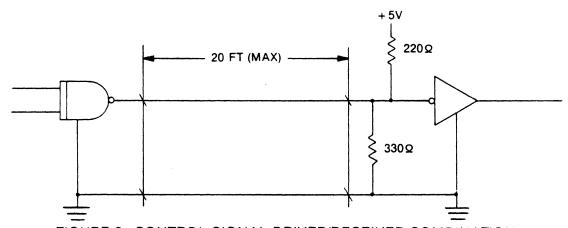
FIGURE 8. CONTROL SIGNAL DRIVER/RECEIVER COMBINATION
