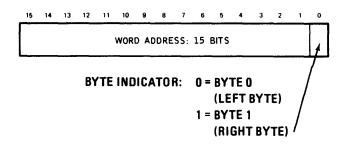
Figure 1-6. Byte Address Format
