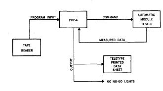
AUTOMATIC MODULE CHECKOUT SYSTEM
