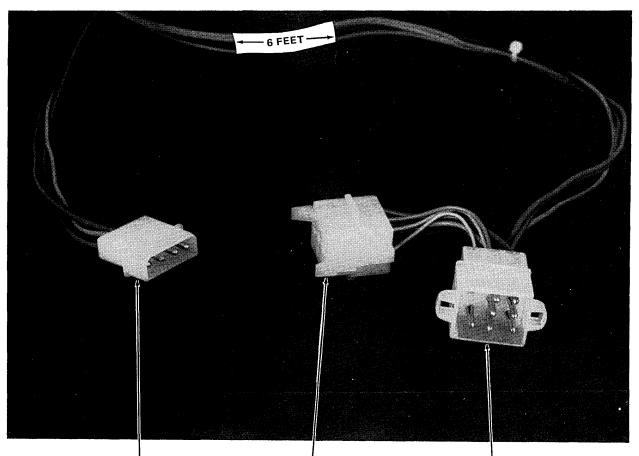
P1, 4 PIN MATE-N-LOK CONNECTOR (CONNECT TO J1 ON EXERCISER FRONT PANEL) J1, 9 SOCKET MATE-N-LOK CONNECTOR (CONNECT TO P1 ON DISK DRIVE POWER HARNESS)
