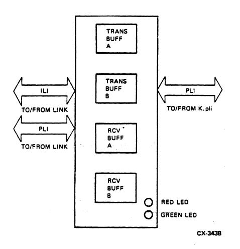
Port Buffer Module (PILA)
