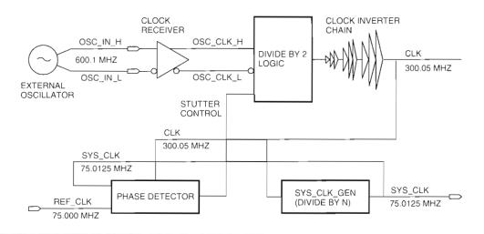
Figure 11 SMPLL Block Diagram
