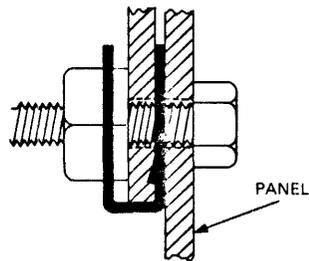
RECOMMENDED ASSEMBLY USING U NUT RETAINER 90-07786-00
