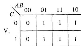
**Figure 1-5.** K-map for  $V = A \cdot \bar{B} + B + A \cdot \bar{B} \cdot C$ .
