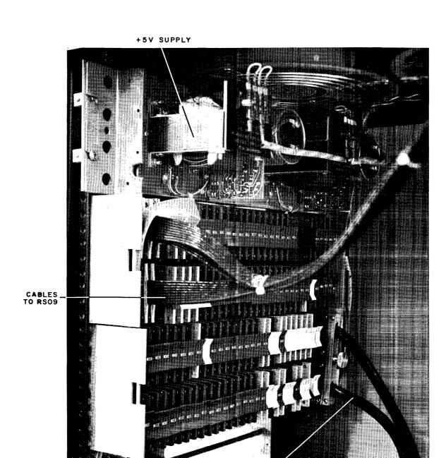
INPUT SIDE OF I/O BUS CABLES
