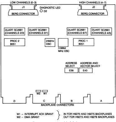
Figure 20-1 • DHV11 Module Layout
