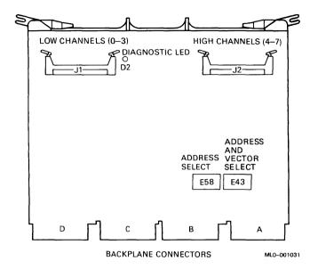
Figure 1: DHV11 Module Layout (M3104)
