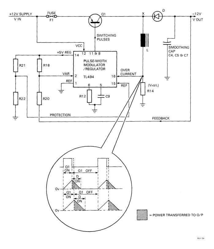
Figure 4-21 DHV11 Voltage Converter
