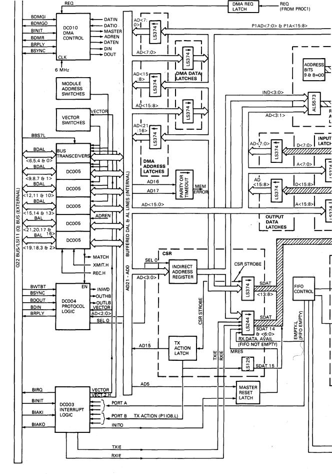
Figure 4-1 DHV11 Block Diagram
