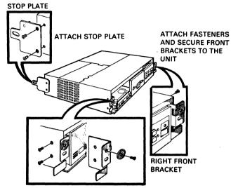
LEFT FRONT BRACKET AND FASTENERS
