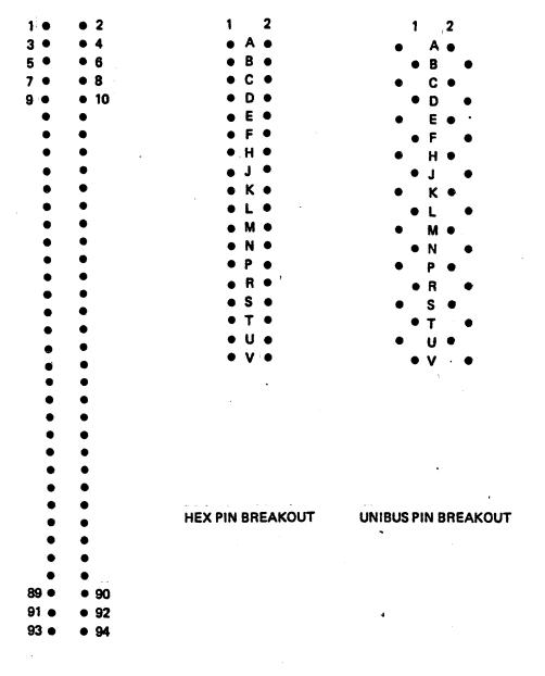
EXTENDED HEX PIN BREAKOUT COMET BACKPLANE PIN BREAKOUTS
