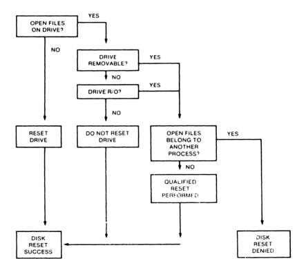
Figure 2-8. Disk System Reset
