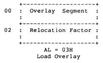
Figure 7-9. EXEC Load Overlay Parameter Block
