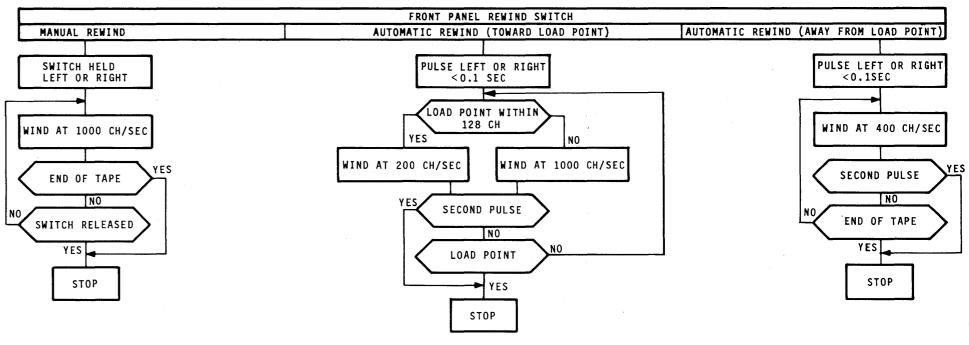
REWIND LOGIC (FRONT PANEL SWITCH)
