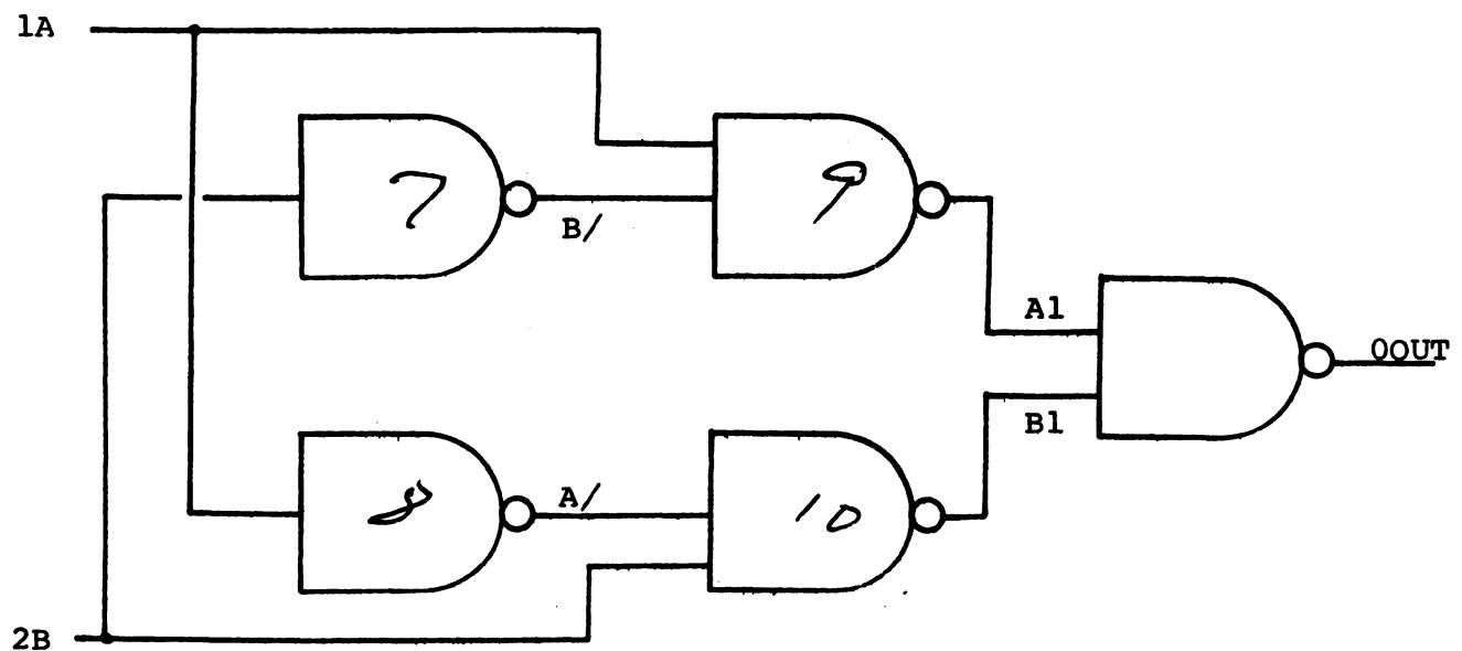
$$\overline{O} = \overline{[A_1 * B_1]} - \overline{A * B}$$
