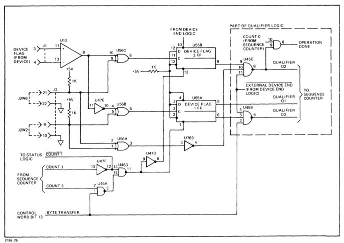
Figure 3-18. Device Flag Edge Detector
