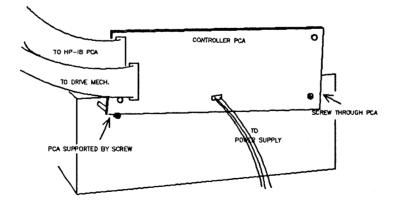
CONTROLLER PCA IN ROTATED TEST-POSITION
