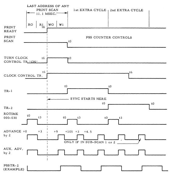
SYNC. ON CLOCK CONTROL TRIGGER GOING POSITIVE AND PRINT. PATTERN SHOULD BE AS SHOWN ABOVE.
