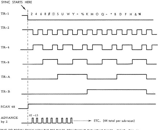
I. JUMPER TO ALLOW PRINTING TO BEGIN ONLY WITH THE PSS PULSE FOLLOWING THE HOME PULSE. SYNC. ON +U SCAN 48 GOING POSITIVE AND PRINT. TRIGGER I SHOULD TURN "OFF" WITH THE FIRST PSS PULSE AND THE PATTERN SHOULD BE AS SHOWN ABOVE. EACH DIVISION IS A CLOCK CYCLE. )II.I MICROSECONDS)
