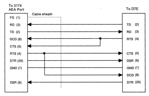
Figure 3-9. Null Modem Wiring
