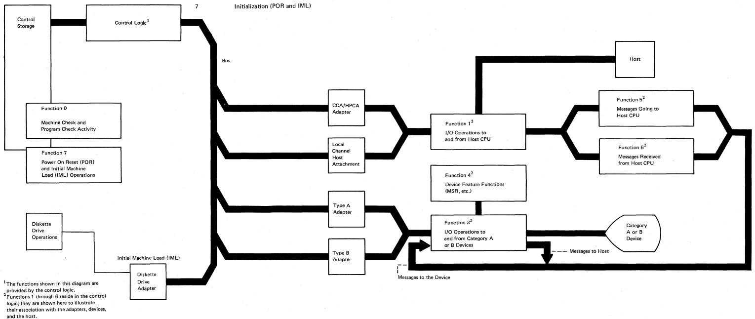
Figure 1-7. 3274 Subsystem Functions
