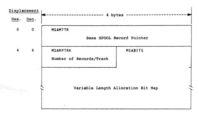
Figure 8.14.1 -- MESSAGE ALLOCATION CONTROL BLOCK
