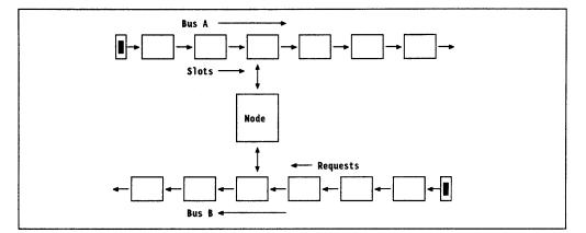
Figure 83. DQDB Medium Access Principle
