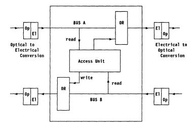
Figure 84. DQDB Node Conceptual Operation
