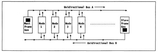
Figure 81. DQDB Bus Structure
