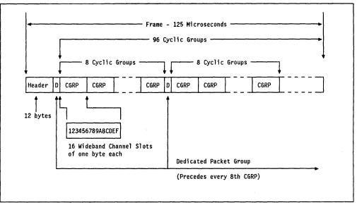
Figure 79. FDDI-II TDM Frame Structure
