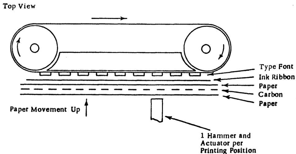
Figure 2-7. Chain Printer
