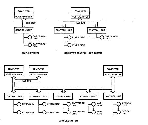
UP TO EIGHT SCSI DEVICES CAN BE SUPPORTED BY THE SCSI BUS. THE DEVICES CAN BE ANY COMBINATION OF HOST CPUs AND INTELLIGENT CONTROLLERS.
